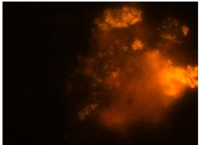
Εικόνα μικροσκοπίου: Νιτροποιητικά βακτήρια εντός των πόρων του Mutag BioChip™
