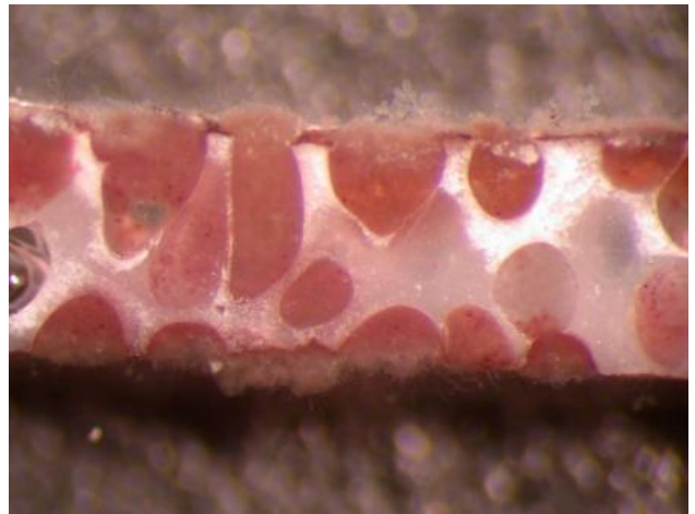
Εικόνα μικροσκοπίου: Νιτροποιητικά βακτήρια εντός των πόρων του Mutag BioChip™
